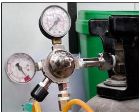
Figura 7.4: Regulador de presión específico para gas \text{CO}_2 .
