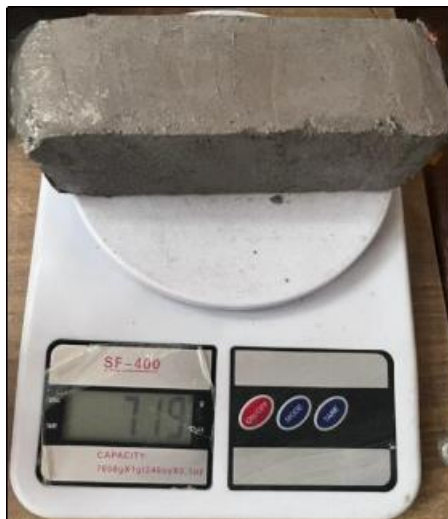
Figura 7.5: Pesaje de muestras inmediatamente posterior al proceso de carbonatación.
