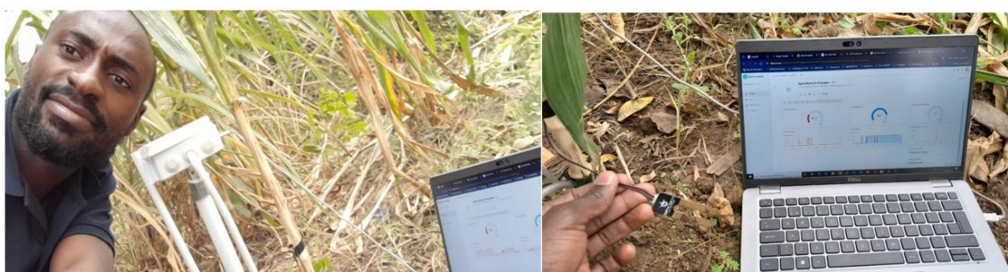
Figura 6 – Monitoramento dos dados pelo computador, teste do sensor de umidade do solo
