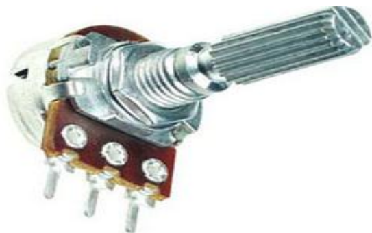
Figura 11 Potenciômetro de eixo giratório. (Fonte: http://www.comofazerascosas.com.br/ )
